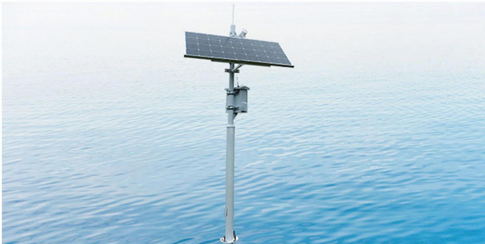
禹山立杆式水质监测站配有无线传输模块，通过无线网络（4G、GPRS、LoRa、Zigbee等）将信息传输至Internet网络，从而实现数据的远程传输。管理中心接收数据后，只要在有Internet网络的地方，不论是笔记本电脑、手机或其他通讯工具，都可以实时查看在线数据、管理传感器等设备。远程查看到设备出现异常可较快的由决策层制定工作计划安排工作人员进行现场排查。
